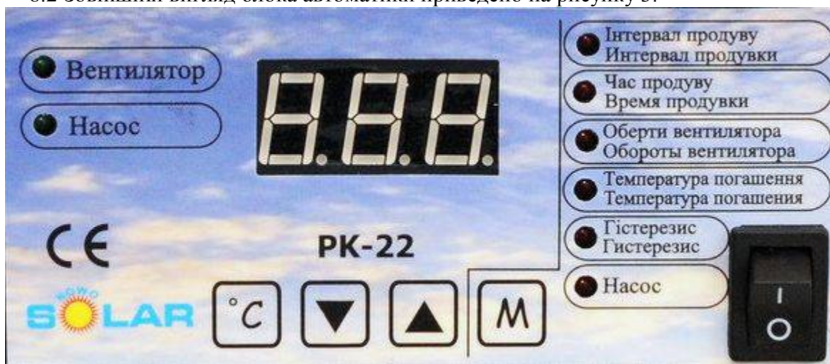
Рисунок 3 – Зовнішній вигляд передньої панелі контролера
